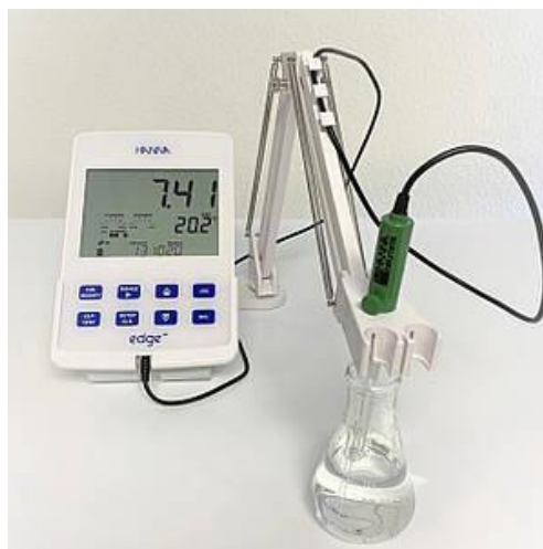
6-сурет – рН-метр Hanna Instruments (ерітінділердің қышқылдығын анықтау үшін)
