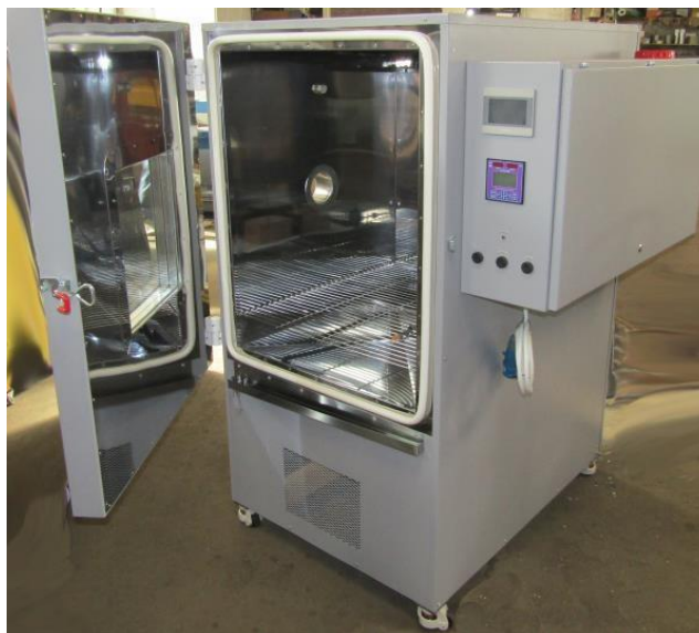
9-сурет – Климаттық камера (сақтау шарттарына бақылау жүргізу үшін)
