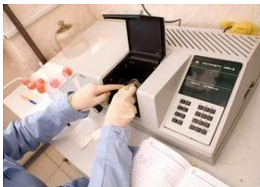
5-сурет – Фотоколориметр КФК-3 (құрамындағы қант концентрациясын анықтау үшін)
